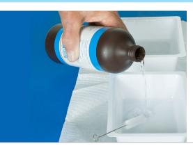
1- Remplissez au quart 1 des 2 gros contenants avec du peroxyde d'hydrogène 3 %.
